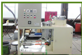
2液接着剤混合塗布装置
